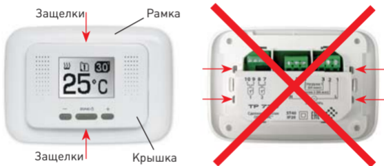
Рис. 9 Снятие крышки прибора
