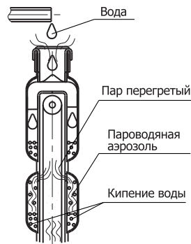
Принцип работы блока парогенератора:
