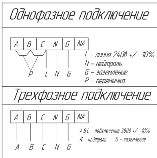
Рис. 4. Схемы подключения электрического котла к электросети.
