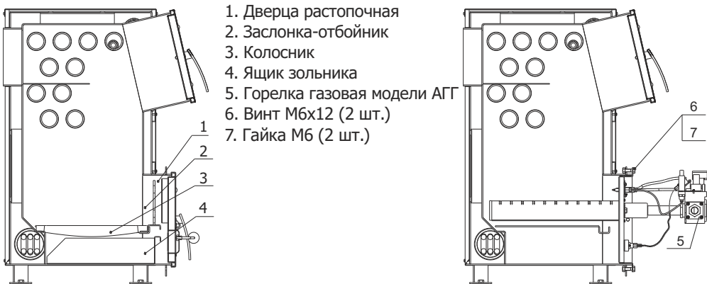
Рис. 8 Схема установки горелки газовой серии АГГ
