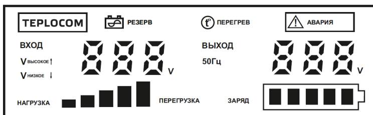
Рисунок 4 — Светодиодный графический индикатор.
