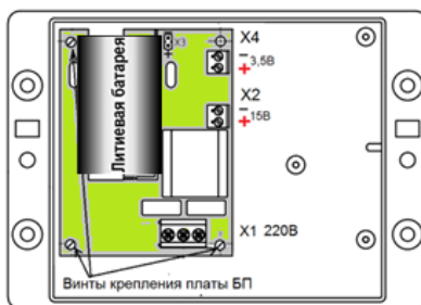
Рис.2 – Схема монтажа БП/ВКТ-7 в корпусе вычислителя
