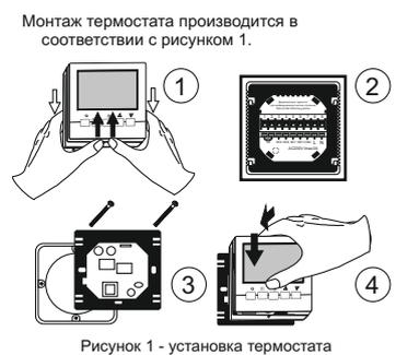
1. Отделите панель с дисплеем от основания с монтажной рамкой, сдвинув его, как показано на рисунке. Отключите шлейф от дисплея.
