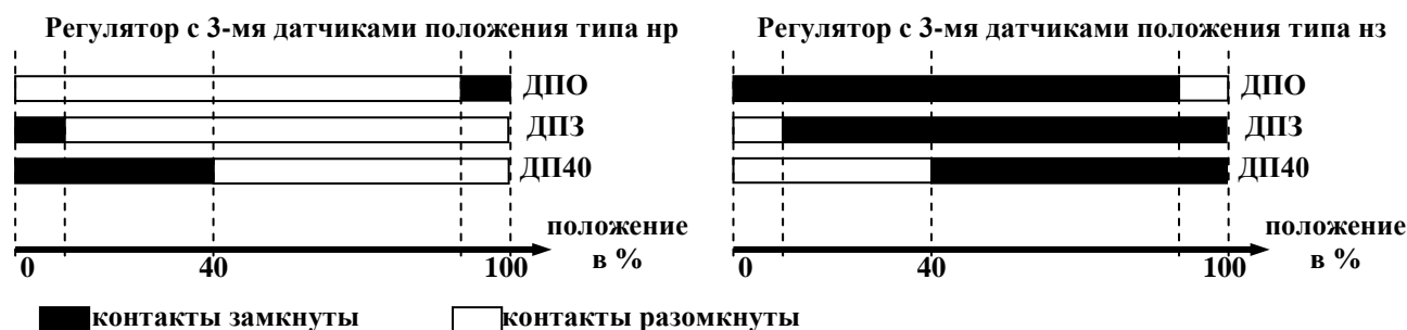
Рисунок 6.6.5.3.1 Состояние контактов регуляторов с 3-мя ДП в зависимости от их типа
