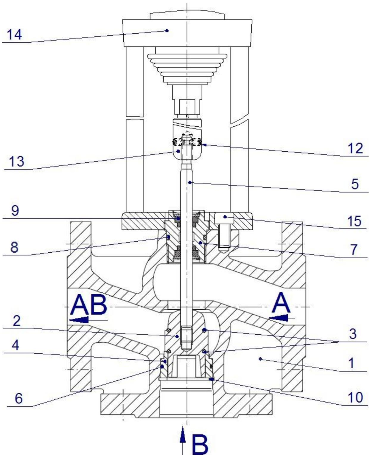
Рисунок А.1 Устройство клапана для DN15-DN50
