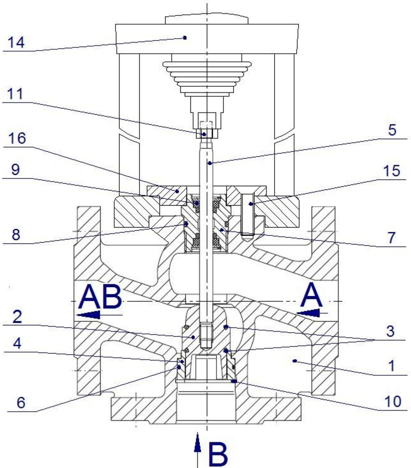
Рисунок А.2 Устройство клапана для DN65-DN100
