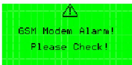
Сигнал неисправности GSM-модема. Проверьте модем.
