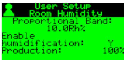
Страница установки пропорционального диапазона увлажнения, включения увлажнителя и установки процента паропроизводительности.
