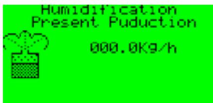
Значение паропроизводительности увлажнителя (при наличии) или отверстия основного парового клапана.
