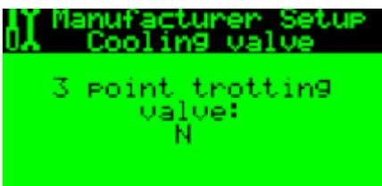
Страница выбора типа клапана для агрегата системы водоохлаждения.
