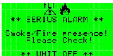
Сигнал задымления/возгорания. Агрегат выключается.
