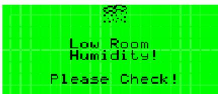
Сигнал низкой влажности в помещении возникает после того, как влажность опускается ниже заданного аварийного порога после заданного времени задержки. Этот аварийный сигнал не выключает агрегат.
