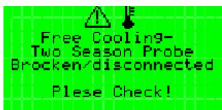
Неисправность или обрыв датчика температуры Естественного охлаждения – Двухсезонного режима.
