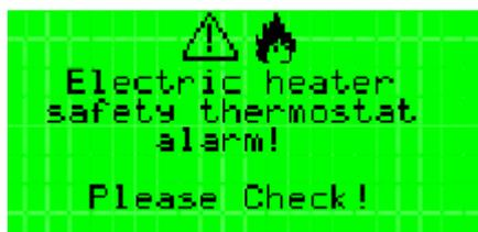
Срабатывание предохранительного термореле на электронагревателе. термореле срабатывает при 115° и перезапускается вручную. Агрегат продолжает работать.
