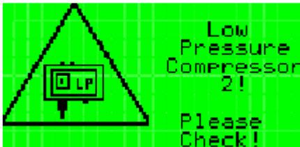
Сигнал низкого давления компрессора 2 (компрессор прекращает работу, а агрегат продолжает работать). Реле давления имеет автоматический сброс, однако аварийный сигнал сбрасывается вручную на микропроцессоре; после сброса аварийного сигнала компрессор запускается автоматически.
