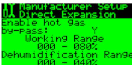
Страница включения клапана нагнетания горячего газа и относительного рабочего диапазона.
