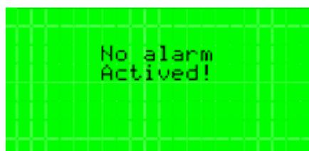
Отсутствуют активные аварийные сигналы. Это сообщение отображается в том случае, если на момент нажатия клавиши Alarm (Аварийный сигнал) отсутствуют активные аварийные сигналы.
