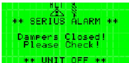
Аварийный сигнал состояния заслонки. Одна или более приводная заслонка закрыта. Агрегат выключается. Проверьте приводные механизмы и работоспособность заслонок.
