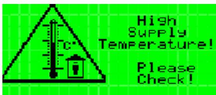
Сигнал высокой температуры приточного воздуха возникает после того, как температура превышает аварийный порог после заданного времени задержки. Этот аварийный сигнал не выключает агрегат.
