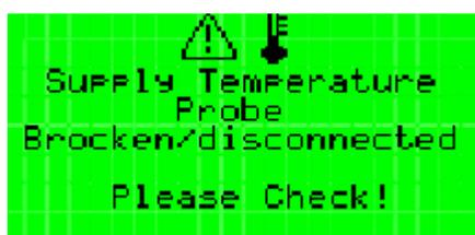
Неисправность или обрыв датчика температуры приточного воздуха.
