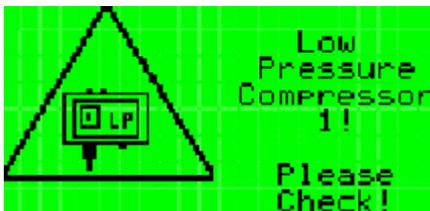
Сигнал низкого давления компрессора 1 (компрессор прекращает работу, а агрегат продолжает работать). Реле давления имеет автоматический сброс, однако аварийный сигнал сбрасывается вручную на микропроцессоре; после сброса аварийного сигнала компрессор запускается автоматически.
