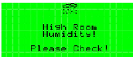
Сигнал высокой влажности в помещении возникает после того, как влажность превышает аварийный порог после заданного времени задержки. Этот аварийный сигнал не выключает агрегат.
