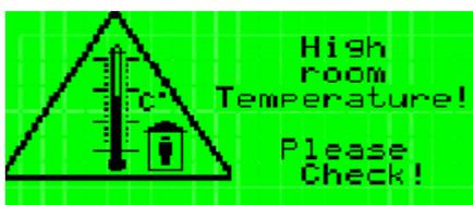
Сигнал высокой температуры в помещении возникает после того, как температура превышает аварийный порог после заданного времени задержки. Этот аварийный сигнал не выключает агрегат.
