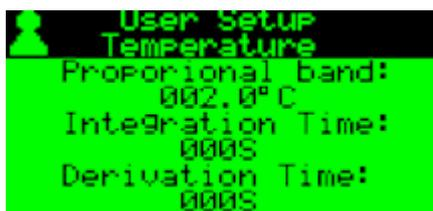
Страница установки значения пропорционального диапазона температуры и установки времени интеграции и отклонения.
