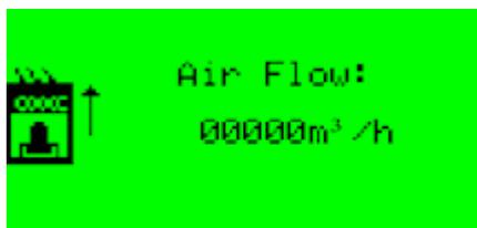
Текущее значение расхода воздуха и давления в помещении (при установленном реле относительного давления).
