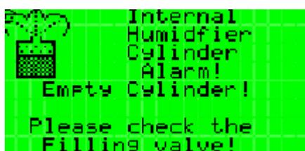
Сигнал пустого цилиндра.
