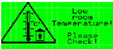
Сигнал низкой температуры в помещении возникает после того, как температура опускается ниже заданного аварийного порога после заданного времени задержки. Этот аварийный сигнал не выключает агрегат.
