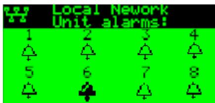
Страница проверки наличия аварийных сигналов агрегатов, интегрированных в локальную сеть.
