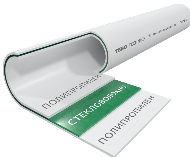
ТРУБА TEBO technics SDR 6, АРМИРОВАННАЯ СТЕКЛОВОЛОКНОМ (PP-R/PP-R-GF/PP-R)
