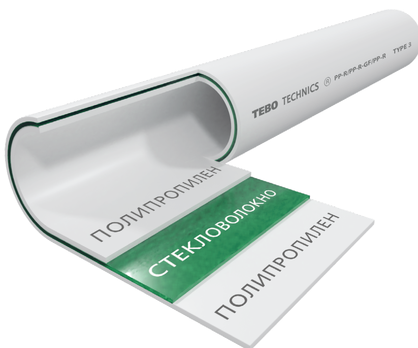
ТРУБА TEBO TECHNICS SDR 6, АРМИРОВАННАЯ СТЕКЛОВОЛОКНОМ (PP-R/PP-R-GF/PP-R)
