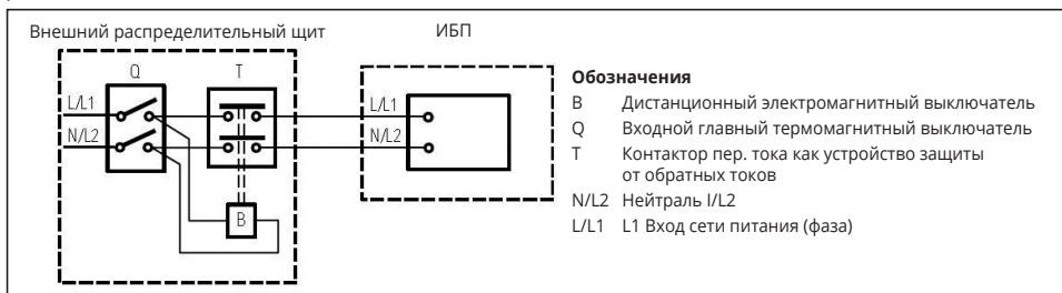
Проводка внешней системы защиты от обратного питания
