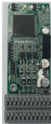
Многофункциональная инкрементная PG-плата SEOP-1527
