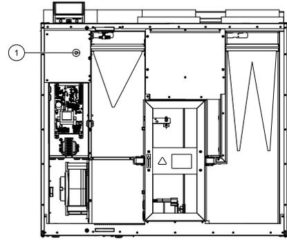
Рис. 7 Кнопка сброса защиты от перегрева
