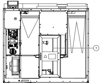
Рис. 6 Приводной ремень ротора
