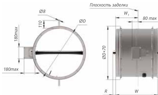
Рис. 8в-2 Размеры nipple'ного клапана HELMER 630-1000 мм, EI90 (с возможностью стеновой заделки).
