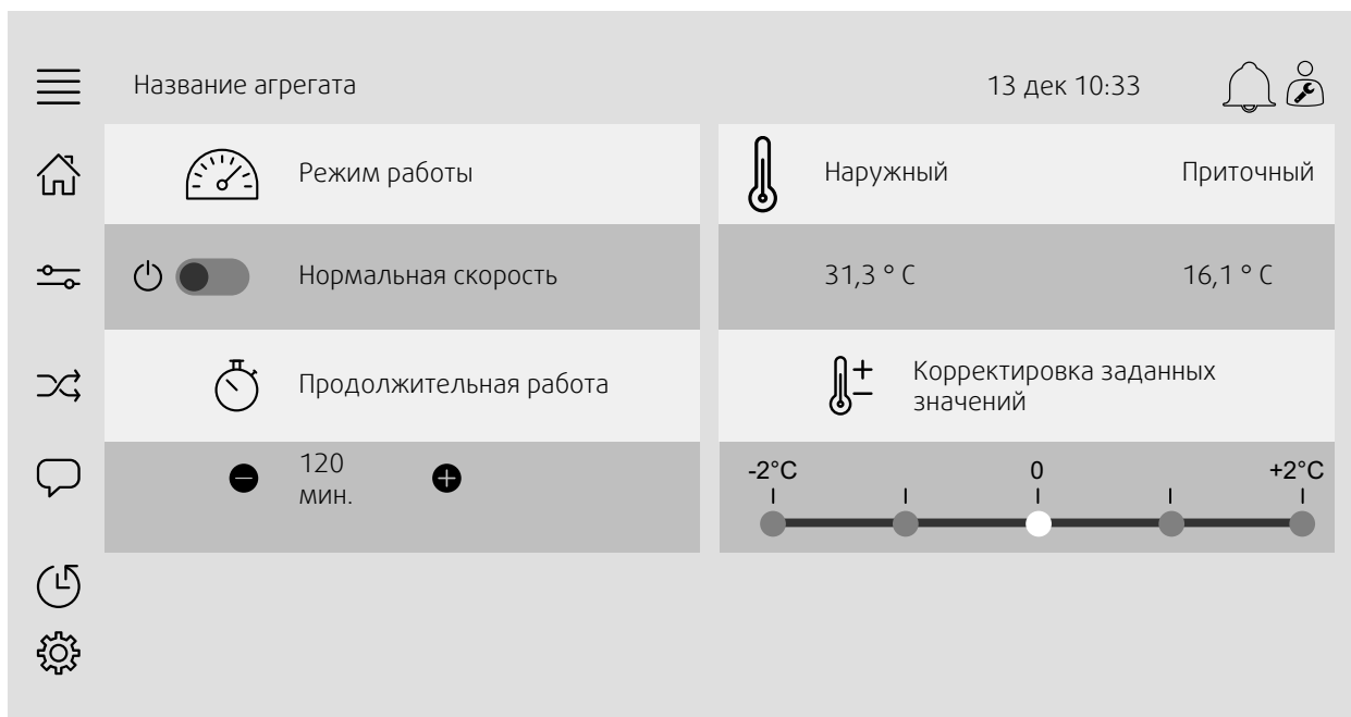
Рисунок 4: На домашней странице представлен обзор состояния работы воздухообрабатывающего агрегата.
