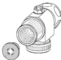
Установка ограничителя расхода
