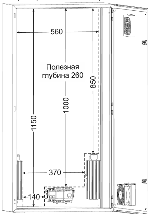
Рисунок 1 – Пространство внутри для установки доп. оборудования
