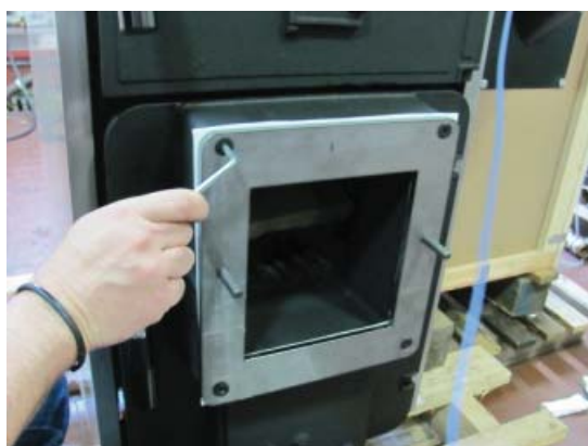
Рис. 23 Фланец, прикрепленный к дверце камеры сгорания
