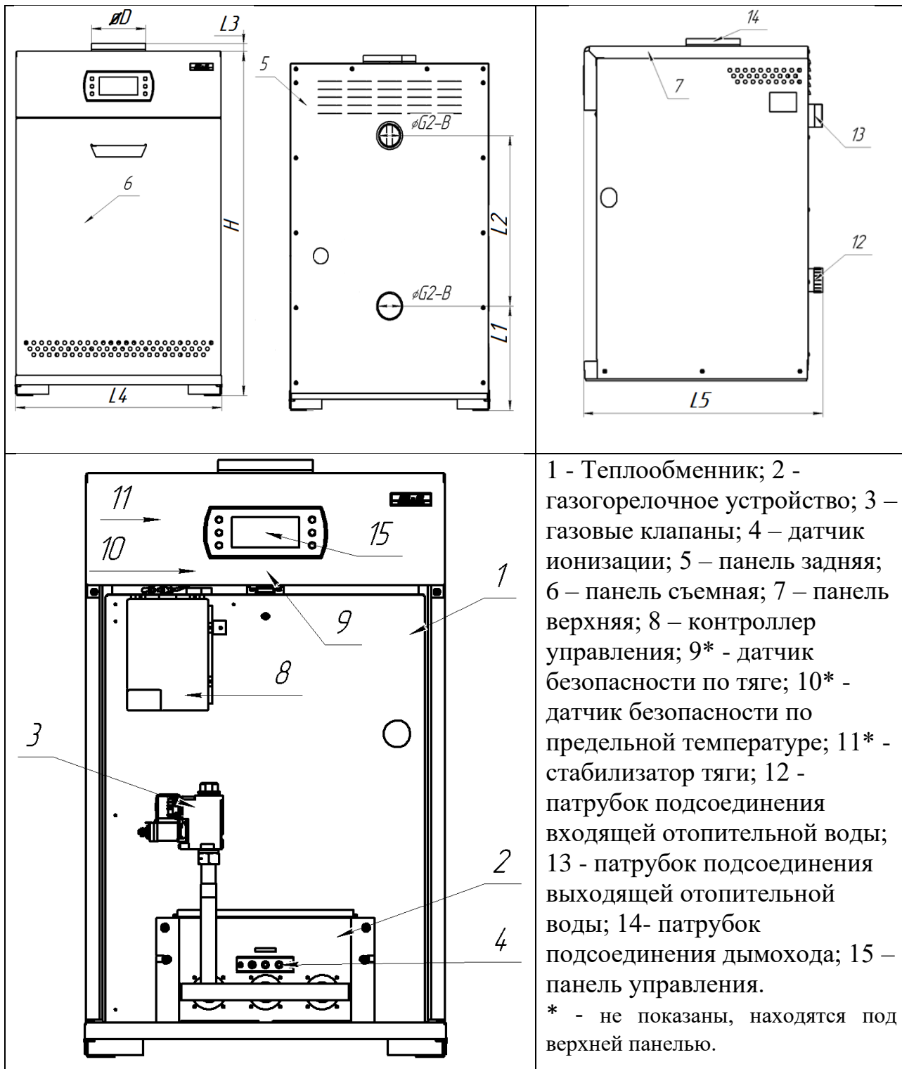
Рисунок 1 – Конструкция котла КОВ-СТ1се
