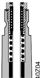
Замена сальников PTFE, включая плоский из меди, для горячей воды повышенной температуры, насыщенных паров, горячего пара и термических масел  $130 \dots 180 \text{ }^\circ\text{C}$
