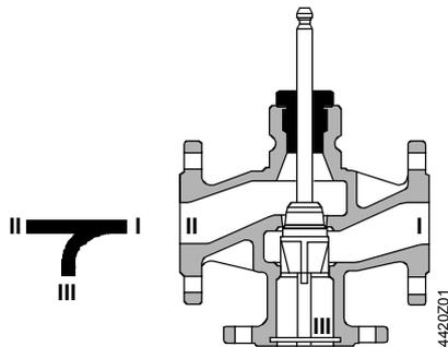
В зависимости от номинального размера, используется регулирующий перфорированный или пазовый плунжер, непосредственно соединенный со штоком клапана
