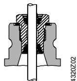
Замена кольцеобразного сальника EPDM-O, включая плоский уплотнитель из меди, для охлажденной воды, горячей воды низкой температуры и рас-сола  $-25 \dots +130 \text{ }^\circ\text{C}$
