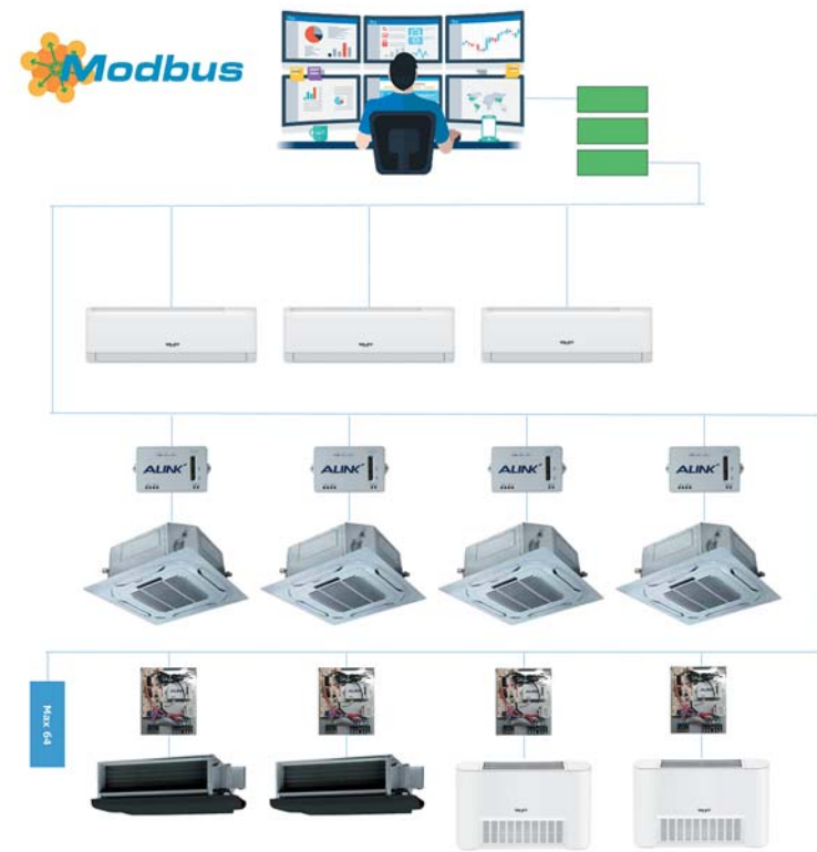
Подключение фанкойлов к системе диспетчеризации
