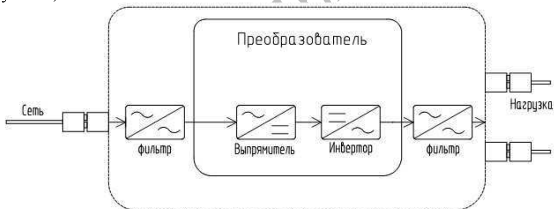
Рисунок 2 - Структурная схема принципа работы стабилизатора
