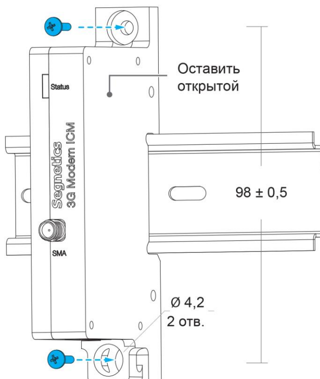
Рис. 8 – Монтаж на DIN-рейку
