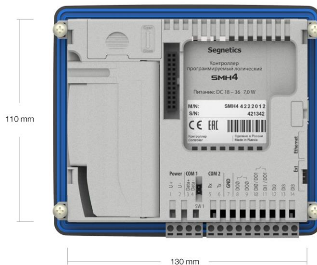
Рис. 7 – Установочные размеры контроллера
