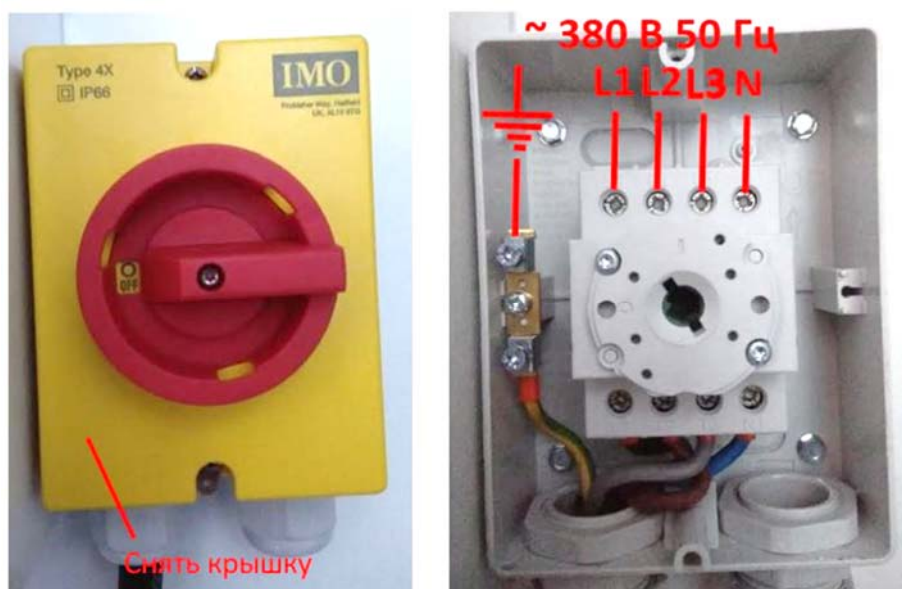
Рисунок 11.1 Подключение электропитания
