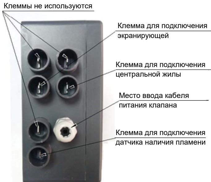
Рисунок 4.3.2 Инфраконтроль IC 3501. Подключение кабелей
