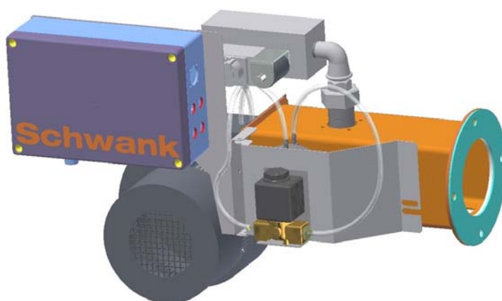
Рисунок 6.4.5 Вид блока горелки после полного переоборудования
