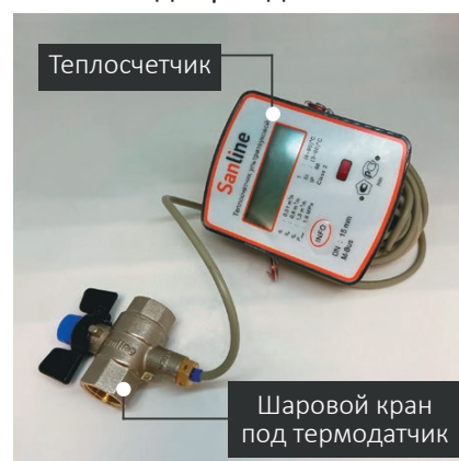
Теплосчетчик совместно с шаровым краном под термодатчик
