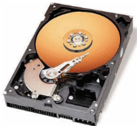
Жесткий диск (внутреннее устройство)
