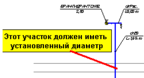
Верхушка противопожарного стояка
