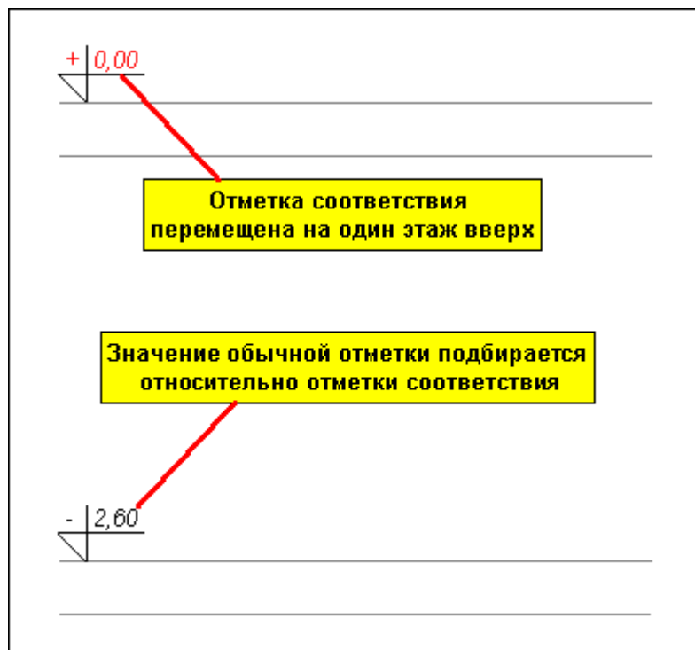
Отметка соответствия помещена на перекрытие первого этажа
