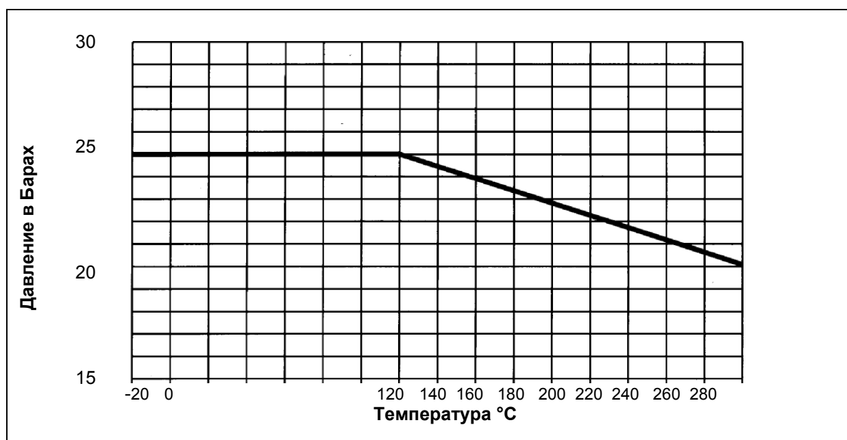
Схема 2: допустимые давление/температура фитингов +S+
