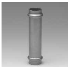
Katalog-Nr. und -bezeichnung 9270S – Schiebemuffe, beidseitig mit Innenpressende
