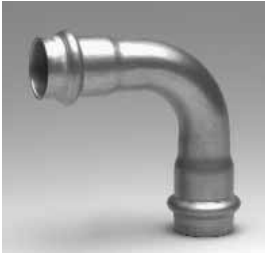
Katalog-Nr. und -bezeichnung 9002A – Bogen 90°, beidseitig mit Innenpressende
