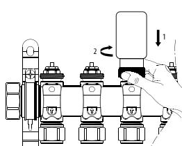
Установите сервопривод на термостатическом клапане обратной гребёнки коллектора тёплого пола. После установки убедитесь, что вы надёжно закрепили сервопривод на коллекторе. Чтобы максимально облегчить установку сервопривода. Сервопривод поставляется изготовителем в полностью открытом состоянии.
