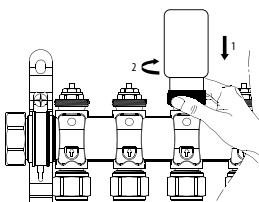
Zamocuj siłownik do zaworu termostatycznego ogrzewania podłogowego na powrocie rozdzielacza. Podczas instalowania upewnij się, że siłownik jest dobrze dokręcony na rozdzielaczu. Aby ułatwić instalację, siłownik domyślnie znajduje się w pozycji całkowicie otwartej.
