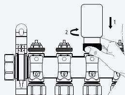
Montați actuatorul cu auto-modulare pe conductă de return a distribuitorului. În timpul instalării, asigurați-vă că THB23030 / THB2430 este strâns complet pe distribuitor. Pentru o instalare cât mai facilă, în cutie veți găsi actuatorul deschis complet.
