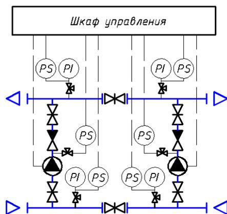
Станция на базе 2х насосов
