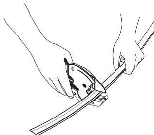
Осторожно. Лезвие ножниц чрезвычайно острое - опасность обрезания при неосторожном использовании! Рука, которой вы держите трубу, должна находиться на безопасном расстоянии от инструмента!
