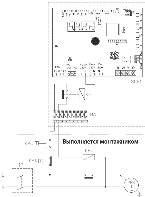
Рисунок 4.7 Электрическая схема соединения насоса рекуператора
