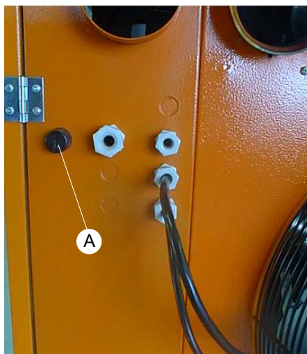
A Защитный колпачок кнопки для сброса предельного термостата
