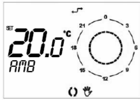
Рисунок 6.7 Форсированная автоматическая работа
