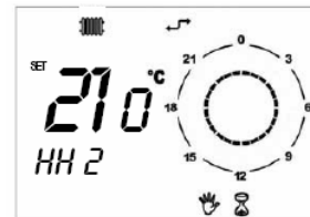
Рисунок 6.9 Ручной режим с таймером (вечеринка)
