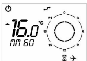
Рисунок 6.8 Режим "выключен с таймером" (программа для отпуска)
