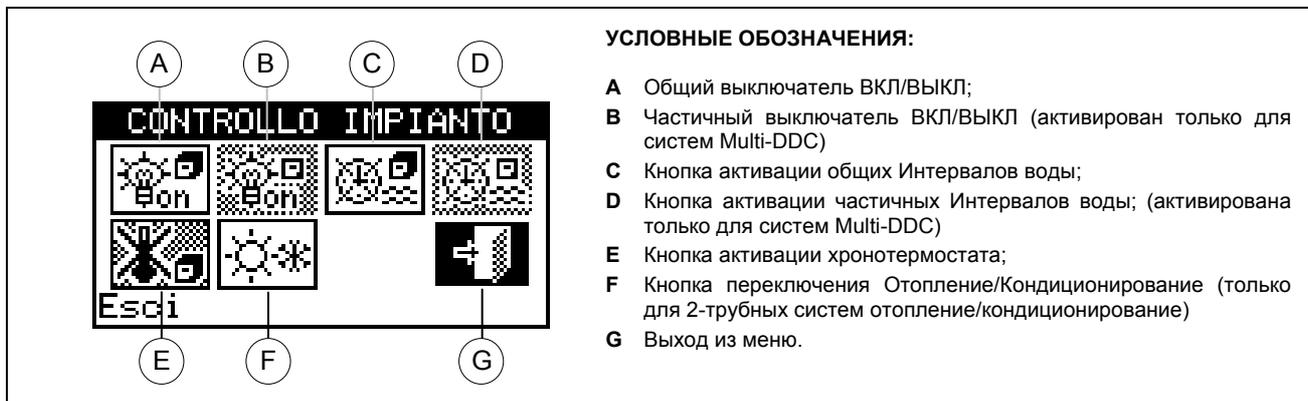
Рисунок 3 – ПРИМЕР СТРАНИЦЫ ДЛЯ КОНТРОЛЯ СИСТЕМЫ КОНДИЦИОНИРОВАНИЯ/ОТОПЛЕНИЯ
