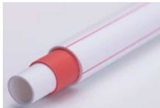
Рис. 2 Конструкция трубы RIIFO Alba PP-R/PP-R-GF/PP-R (трёхслойная).
