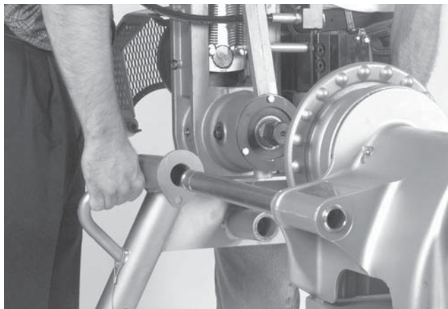
Рисунок 4 – Надевание желобонакатчика на опорные рычаги
