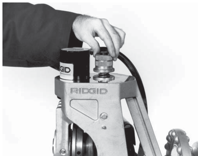
Рисунок 8 – Крупный план ручки регулировки глубины, повернутой вниз к верхнему кожуху
