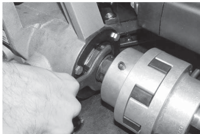
Рисунок 14 – Ослабление и снятие стопорной ведущего вала
