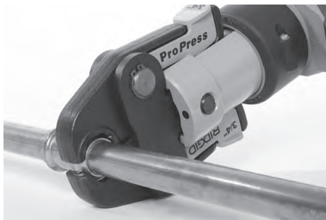
Εικόνα 9 – Τοποθέτηση σιαγόνων τύπου ψαλιδιού γύρω από τον σύνδεσμο
