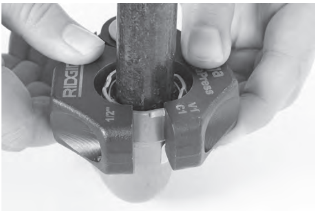
Figur 11 – Sätta dit pressringen på beslaget
