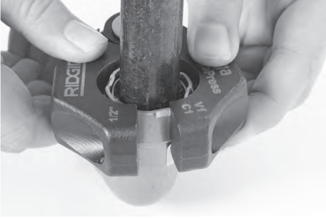
Şekil 11 – Pres Halkasının Tespit Elemanının Üzerine Takılması
