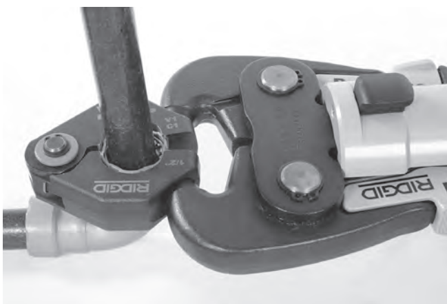
Kuva 12 – Käyttölaitteen kiinnittäminen puristusrenkaaseen
