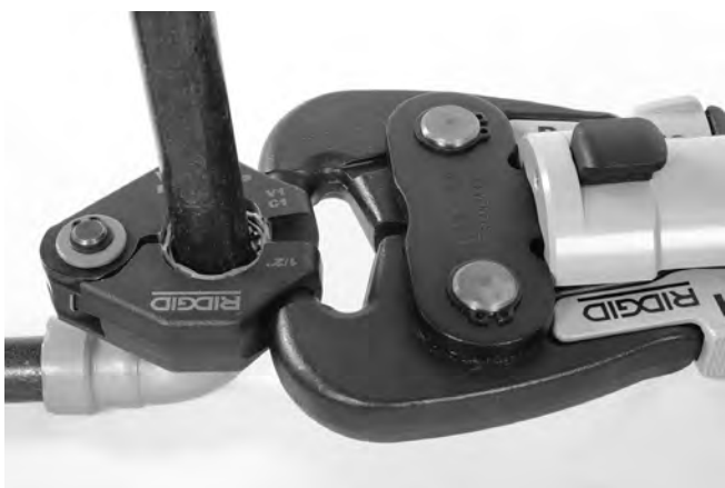
Obrázok 12 – Pripojenie akčného členu k lisovaciemu krúžku
