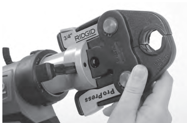
Figura 7 - Perno di montaggio dell'accessorio
