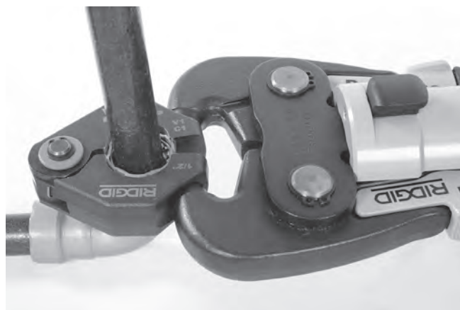
Figura 12 – Prender o Atuador no Anel de Prensagem
