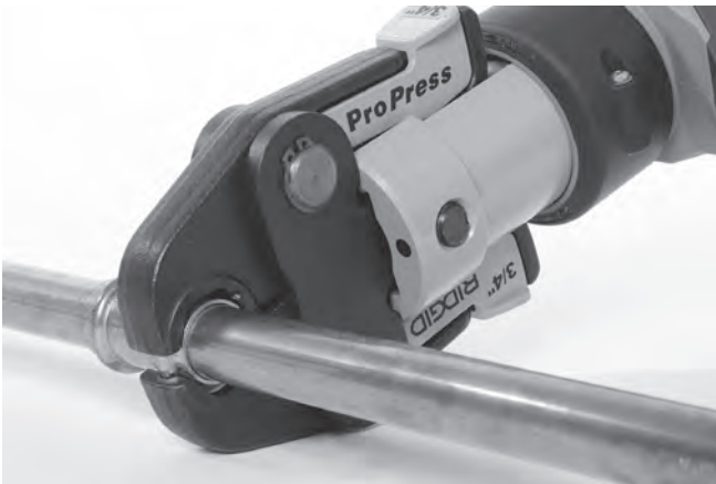
Figur 9 – Placera käftar av saxstil runt beslaget
