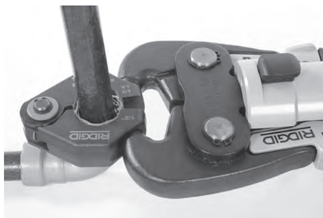
Figura 12 – Atașarea actuatorului la inelul de presare
