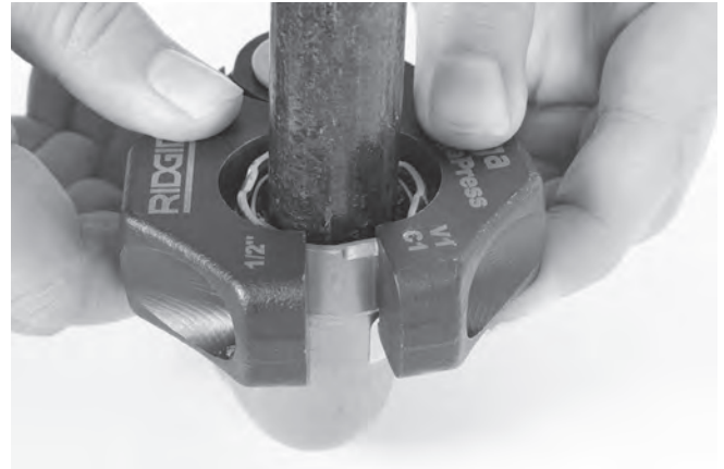
Εικόνα 11 – Τοποθέτηση δακτυλίου προσαριστής σύνδεσης στον σύνδεσμο
