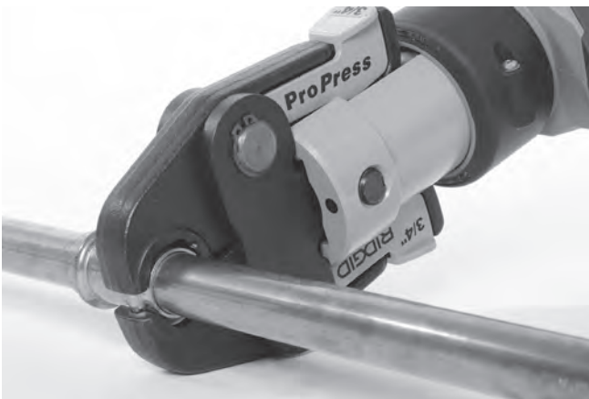
Obrázek 9 – Umístění nůžkových čelistí kolem armatury
