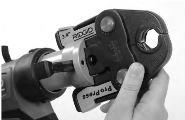
Рис. 7 – Штифт крепления насадки
