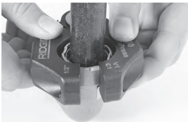
Kuva 11 – Puristusrenkaan asentaminen liittimeen
