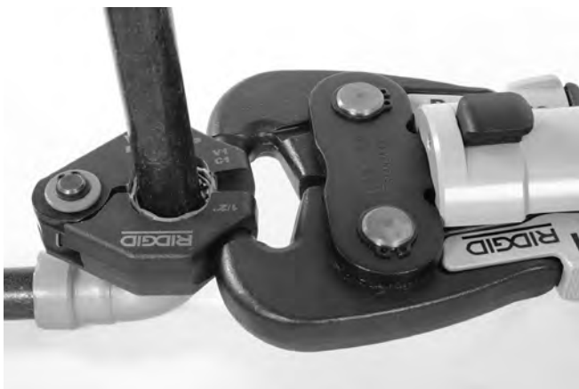
Рис. 12 – Крепление рабочей насадки на обжимном кольце
