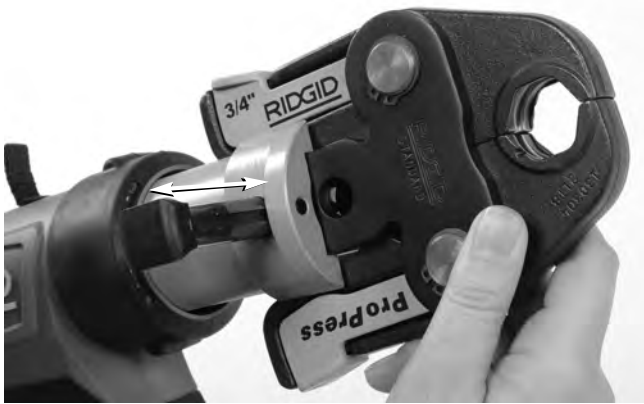
Figure 7 – Broche de montage de tête
