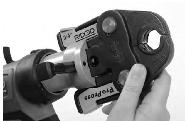
Slika 7 - Montažni zatič priključka
