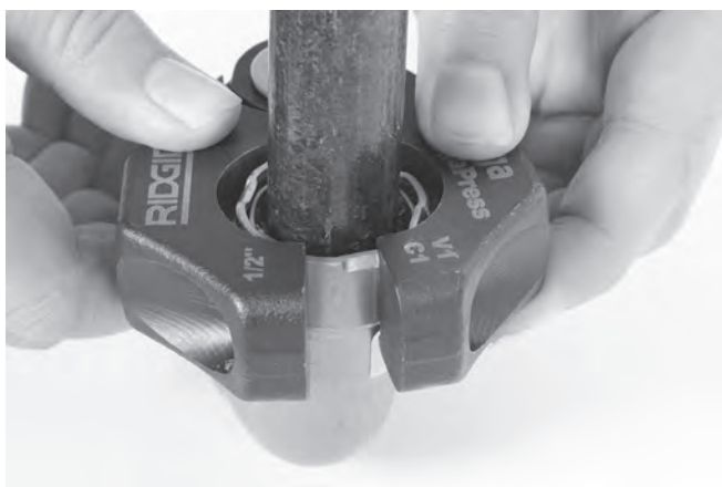
Figura 11 – Instalar o Anel de Prensagem no Engaste
