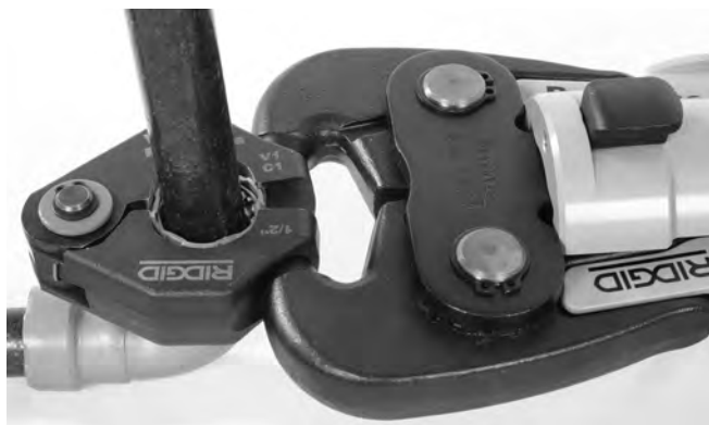
Figura 12 – Montaje del accionador en el aro sellador
