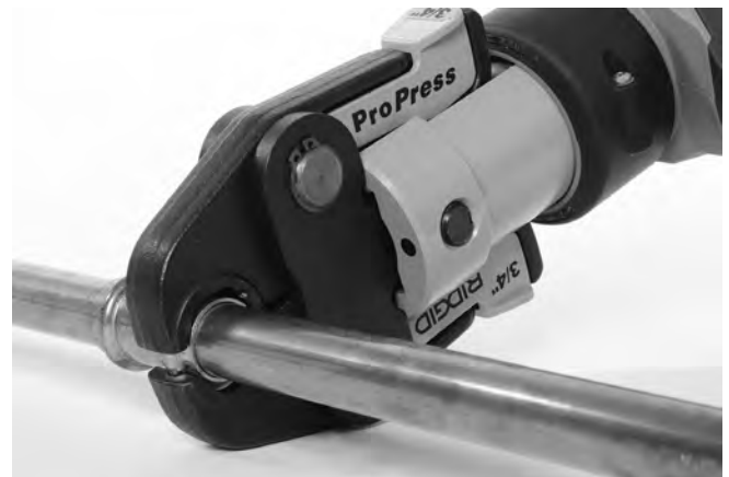
Slika 9 – Nameščanje škarjastih čeljusti okoli nastavka
