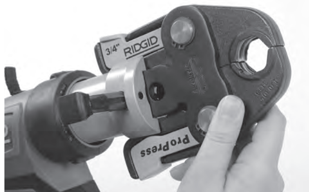
Figura 7 - Cavilha de montagem do acessório
