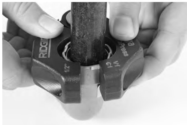
Slika 11 – Montaža prstena za prešanje na priključak
