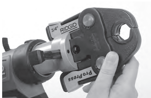
Figur 7 – Monteringspinne for tilbehør
