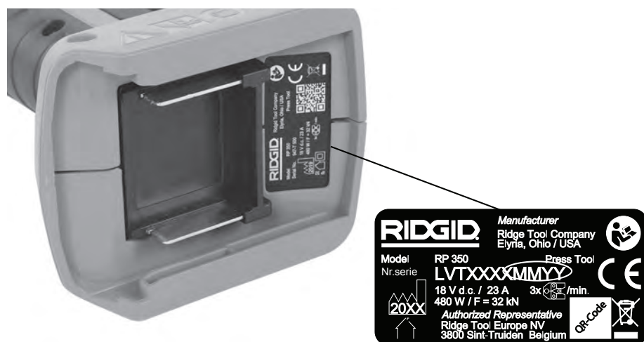
Figura 3 – Numărul de serie al mașinii - Cifrele încercuite indică anul și luna fabricației. (YY = anul, MM = luna).
