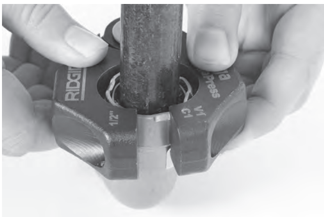
Abbildung 11 – Anbringen des Pressrings am Fitting
