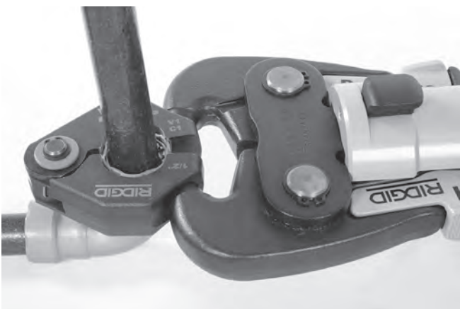
Figur 12 – Fästa aktuatoren på pressringen
