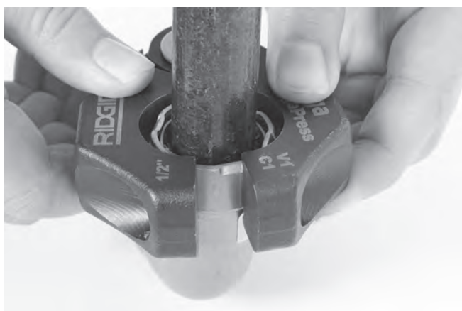
Figura 11 – Montarea inelului de presare pe fitting
