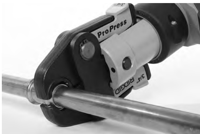
Slika 9 – Postavljanje čeljusti u obliku škara oko umetka
