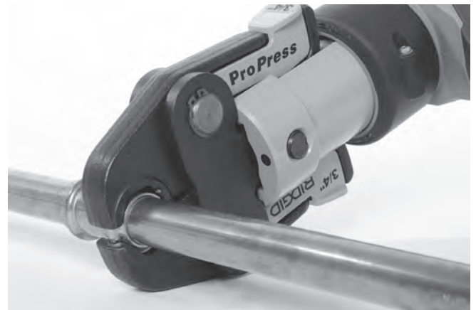
Figura 9 - Collocamento di ganasce di stile a forbice intorno al raccordo
