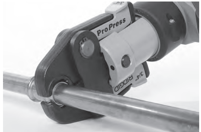
Abbildung 9 – Anbringen von Scherenbacken am Fitting
