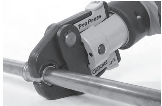
Rys. 9 – Umieszczanie szczęk nożowych wokół okucia
