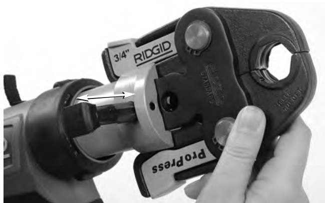
Figura 7 – Pasador de montaje de accesorios
