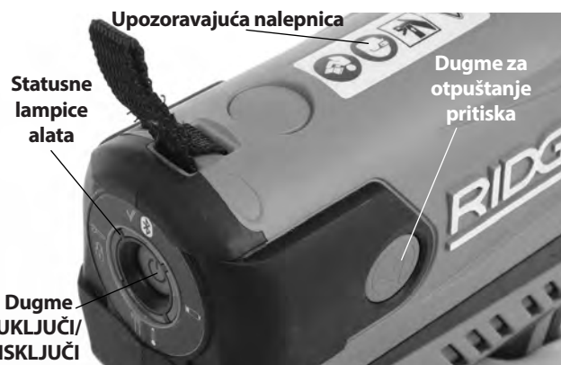
Slika 6 - Statusne lampice/upozoravajuća nalepnica
