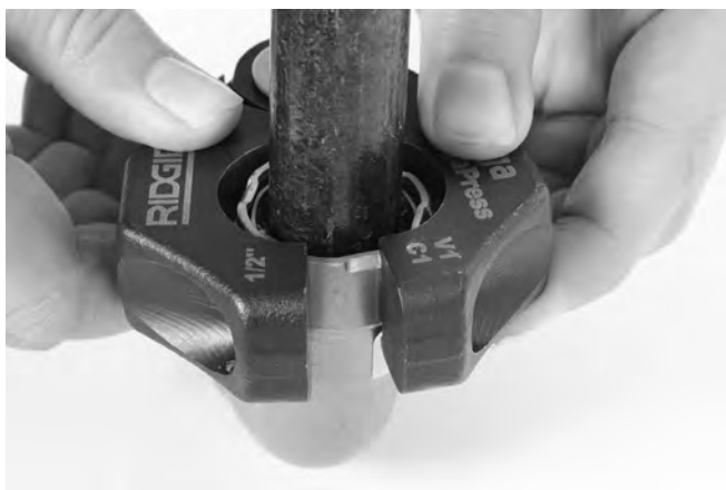
11. ábra - Présgyűrű elhelyezése a csőcsatlakozón
