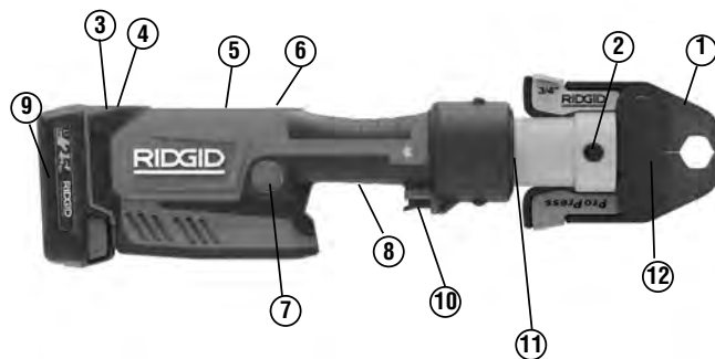
Slika 2 – Alat za prešanje RIDGID RP 351 i čeljusti serije Standard
