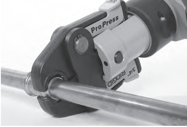
Şekil 9 – Makas Tipi Çeneleri Tespit Elemanın Etrafına Yerleştirme
