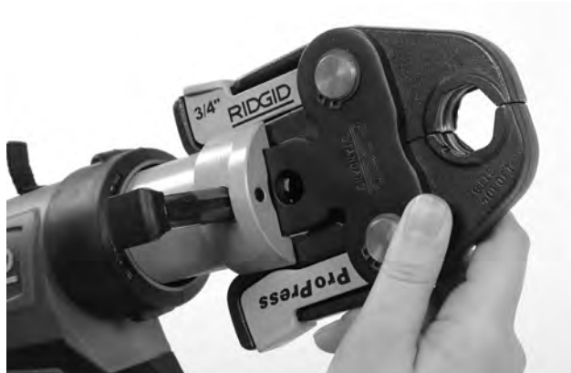
7. ábra – Szerelékrogzító csap
