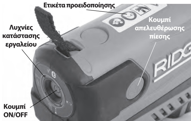
Εικόνα 6 - Λυχνίες κατάστασης/Ετικέτα προειδοποίησης
