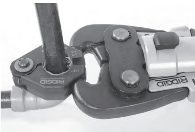
Figur 12 – Fastgørelse af aktuator på pressering
