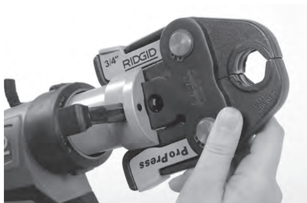
Rys. 7 – Sworzeń montażowy osprzętu
