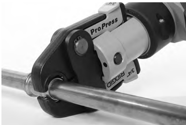
Slika 9 - Postavljanje makazastih čeljusti oko priključka
