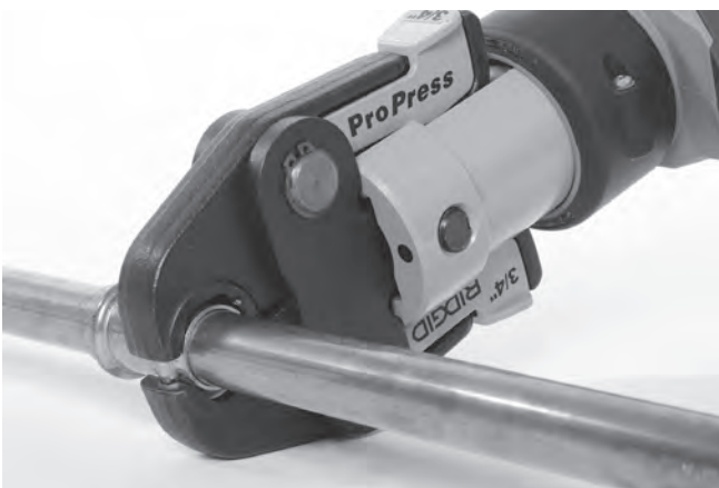
9-сурет – Қайшы тәрізді қармауыштарды фитинг айналасына орналастыру
