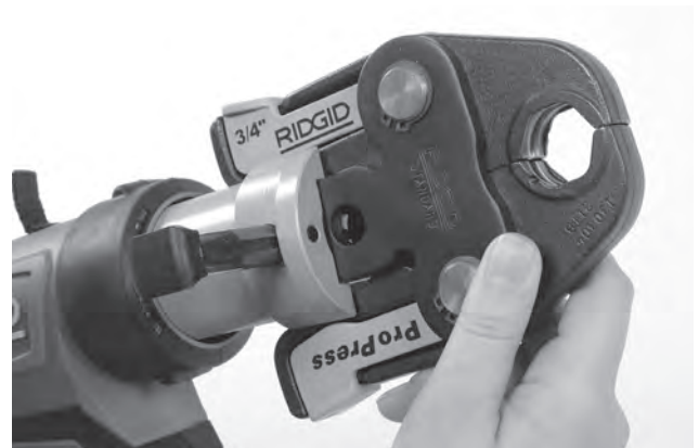
Εικόνα 7 - Πείρος στερέωσης εξαρτήματος
