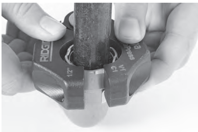
Obrázek 11 – Instalace lisovacího kroužku na armaturu
