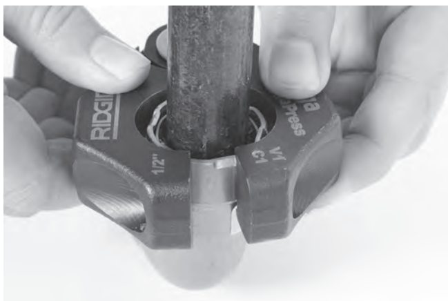
Figur 11 – Installere pressringen på utstyret
