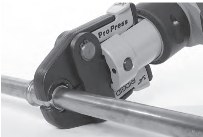
Kuva 9 – Saksityyppisten leukojen asettaminen liittimen ympärille
