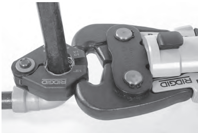
Figur 12 – Feste aktuatoren til pressringen
