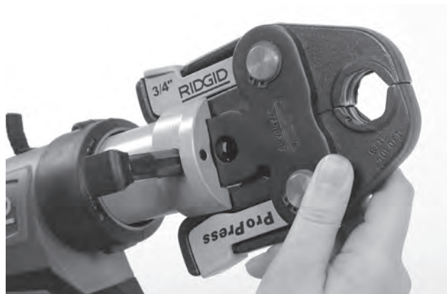
Figura 7 – Știft montaj atașament
