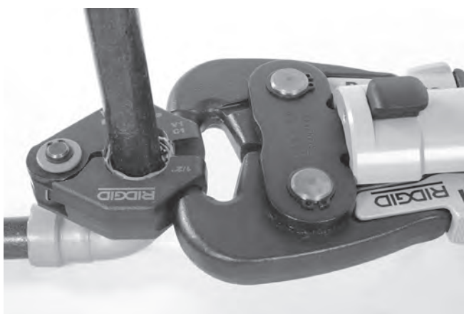
Obrázek 12 – Připojení pohonu k lisovacímu kroužku
