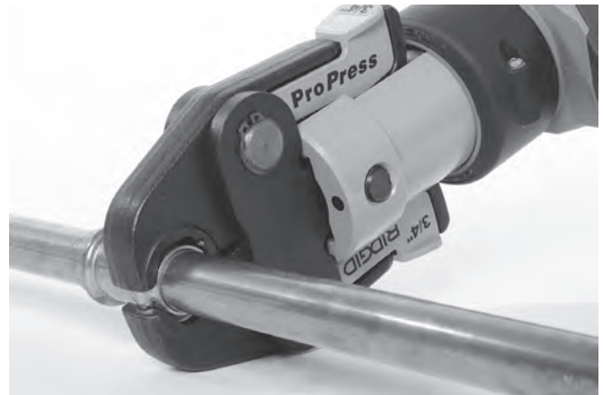
Figura 9 – Colocar os mordentes estilo tesoura à volta do engaste
