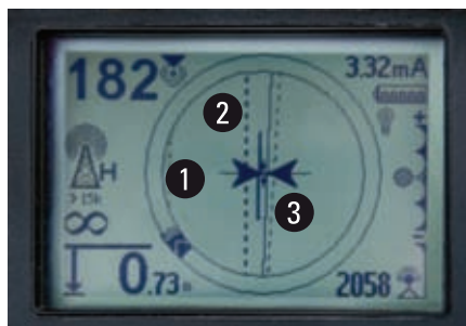
Экран в режиме Omniseek: Отображаются несколько линий (на фотографии показаны три разные коммуникации) 1, 2, 3.
