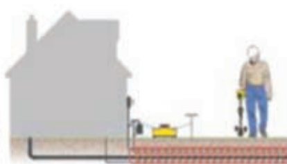
Обнаружение с помощью линейного передатчика (прямое подключение).
