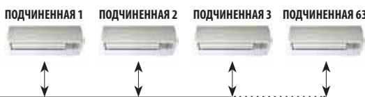
УПРАВЛЕНИЕ ВЕДУЩИЙ/ПОДЧИНЕННЫЙ ДО 64 БЛОКОВ НА ОБЩЕЕ РАССТОЯНИЕ ДО 1200 м
