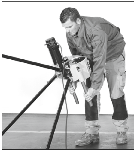
Fig. 2: Aufstellen der Maschine Fig. 2: Putting up the machine Fig. 2: Pose de la machine Fig. 2: Raddrizzamento della macchina Fig. 2: Instalación de la máquina Fig. 2: Plaatsen van de machine Fig. 2: Uppställning av maskinen Fig. 2: Oppstilling av maskinen Fig. 2: Opstilling af maskinen Kuva 2: Koneen pystytys Fig. 2: Instalação da máquina Rys. 2: Ustawianie maszyny Obr. 2: Stroj postaviti Obr. 2: Stroj postaviti 2. ábra: Felállítani a gépet Sl. 2: Postavljanje stroja Slika 2: Postavitev stroja Fig. 2: Amplasarea maşinii Фиг. 2: Установка станка Εικ. 2: Τοποθέτηση της μηχανής Resim 2: Makinenin kurulumu Фиг. 2: Монтаж на машината 2 pav.: Staklių pastatymas Att. 2: Mašinas uzstādišana Joonis 2: Masina ülespanek
