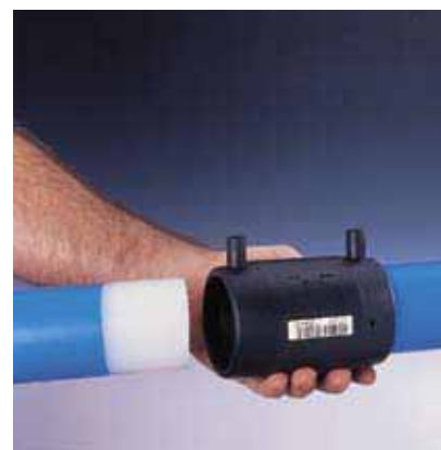
Рис. 34 8. Вставить конец второй трубы в муфту. Зачищенная зона должна полностью уйти в электросварную муфту
