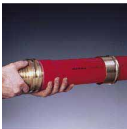
Рис. 18 4. Вставить фитинг в развальцованную трубу. Через небольшое время труба плотно обожмет фитинг (эффект памяти формы)
