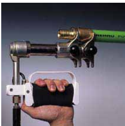
Рис. 13 7. Свести запрессовочные насадки инструмента (тиски) и надвинуть гильзу до ее упора в край фитинга
