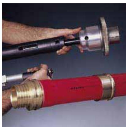
Рис. 19 5. Снять расширительную насадку
