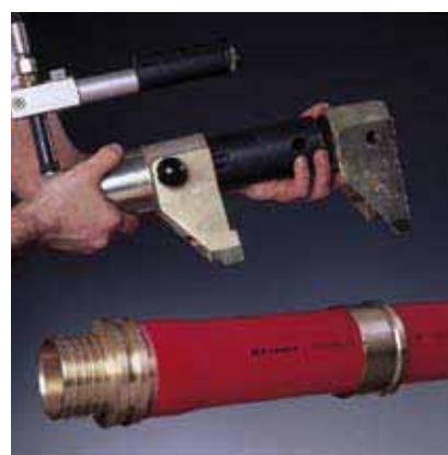
Рис. 20 6. Надеть запрессовочную насадку на цилиндр
