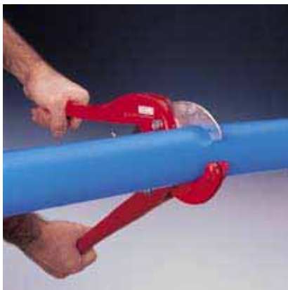
Рис. 27 1. Отрезать трубу по размеру под прямым углом
