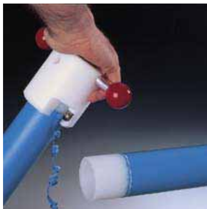
Рис. 30 4. При использовании устройства для зачистки можно не отмечать диапазон отрезки
