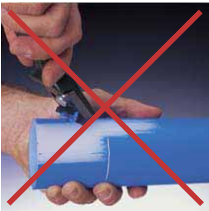
Рис. 56 Не удаляйте верхний слой за пределами отметок
