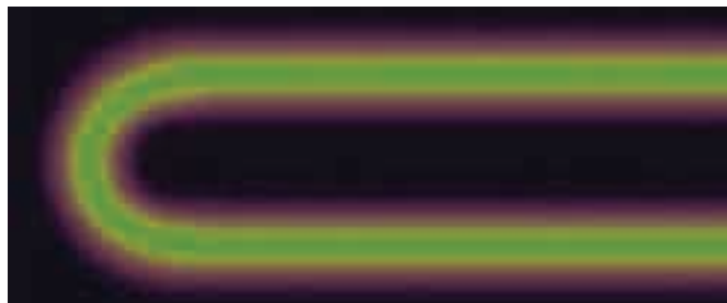
Рис. 5-8 Поиск мест прокладки труб, по которым движется теплоноситель
