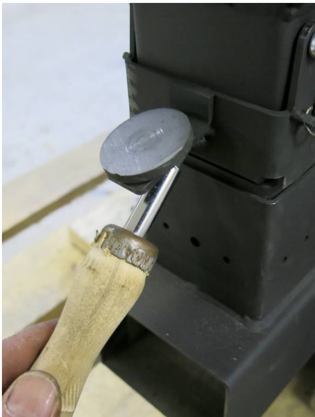
Рис. 27 - Взведение шиббера (защита шиббера условно не показана, ручка может иметь иной вид)
