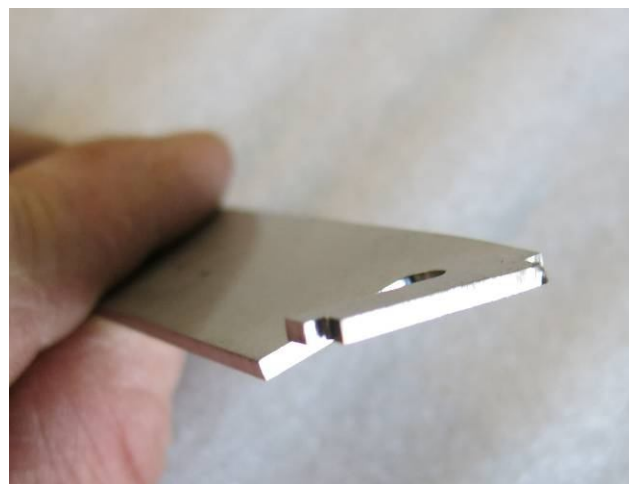
Рис. 34 - Отгибание краев полки
