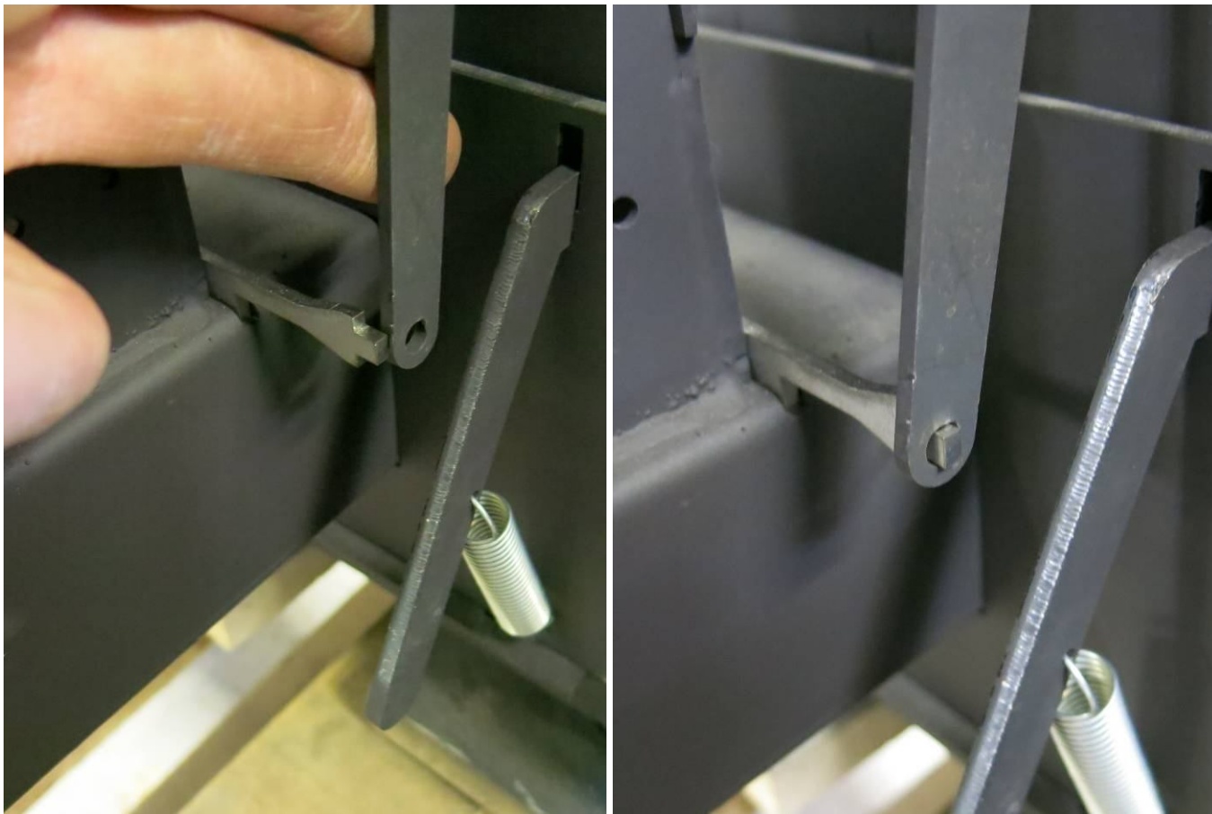
Рис. 25 - Установка тяг регулятора
