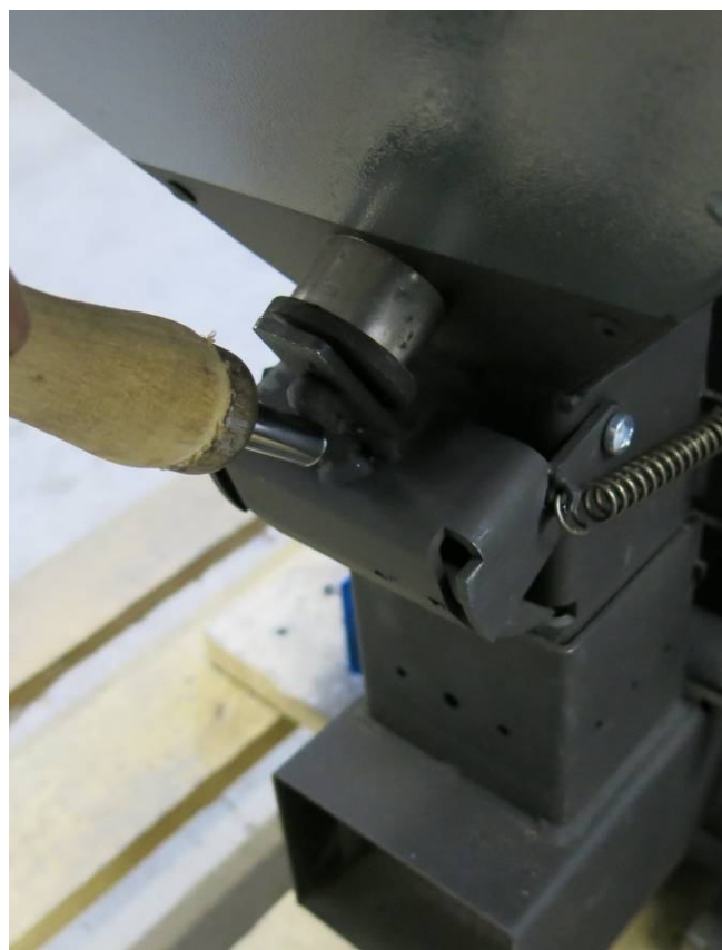
Рис. 27 - Взведение шиббера (защита шиббера условно не показана, ручка может иметь иной вид)
